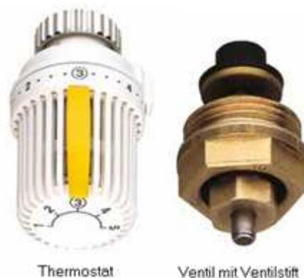
3. Sollte der Stift klemmen, kann das Thermostat das Ventil und damit die Temperatur nicht mehr steuern. Versuchen Sie, mit leichten Hammerschlägen gegen den Ventilkörper (oder ganz leicht gegen den Stift), den Stift zu lösen.
